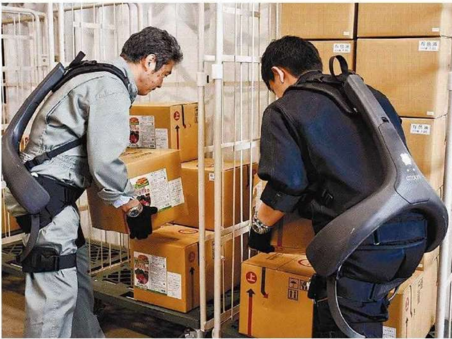
パワースーツを装着し、工場作業を行う環境大善の従業員
